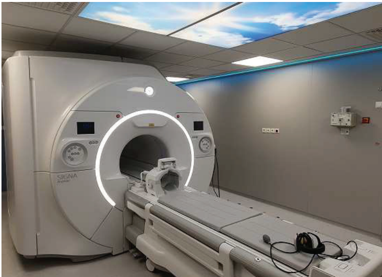
Figure 7 : Imageur IRM 3T de marque General Electric utilisé à ce jour au Centre Cyceron ( Photo GIP Cyceron ).
